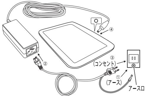
図の①②③④の順に接続してください。取り外す時は逆の順序で取り外してください。
